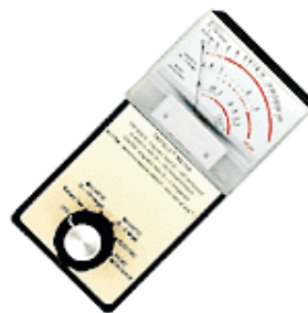
Fig. 48: Strumento per la rilevazione di radiazioni elettromagnetiche
